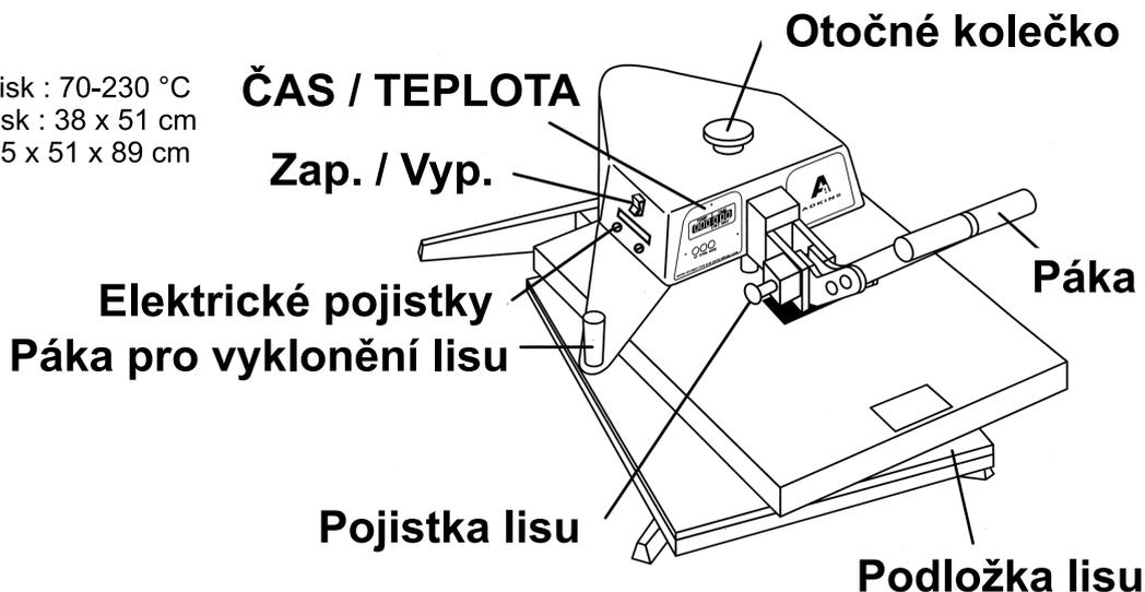
Zařízení umístěte na pevný a rovný stůl, s dostatečným prostorem okolo tepelného lisu ( z důvodu vyklápění do strany ). Tlak tepelného lisu se nastavuje pomocí otočného kolečka, umístěného na vrchní straně lisu. Otočení vpravo se přítlak zvyšuje, otočením vlevo se přítlak snižuje.
